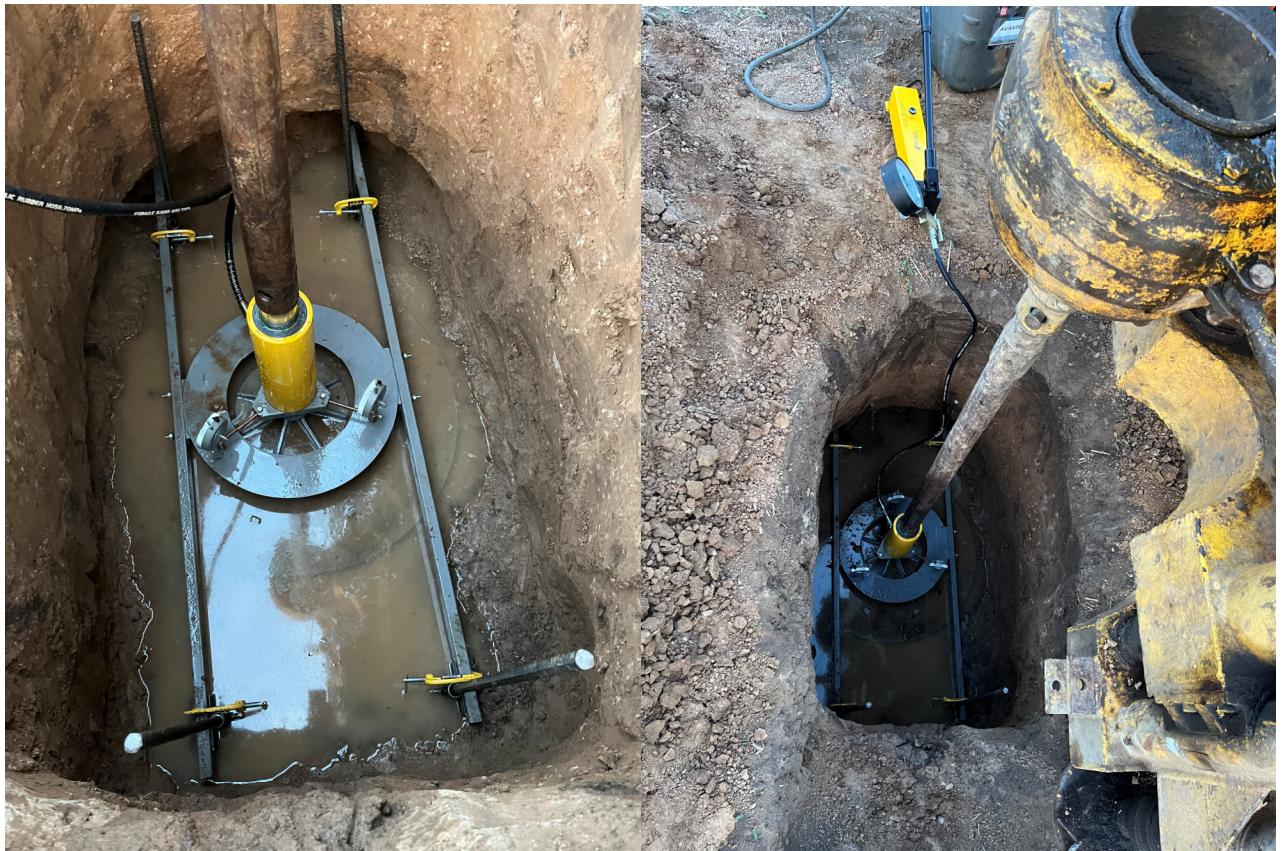
Фото 6 – Выполнение штамповых испытаний в замоченном состоянии (штамп 5000 см 2 )
