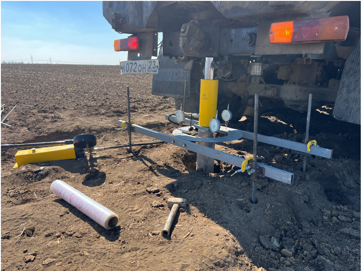
Фото 5 – Выполнение штамповых испытаний (штамп 600 см 2 )
