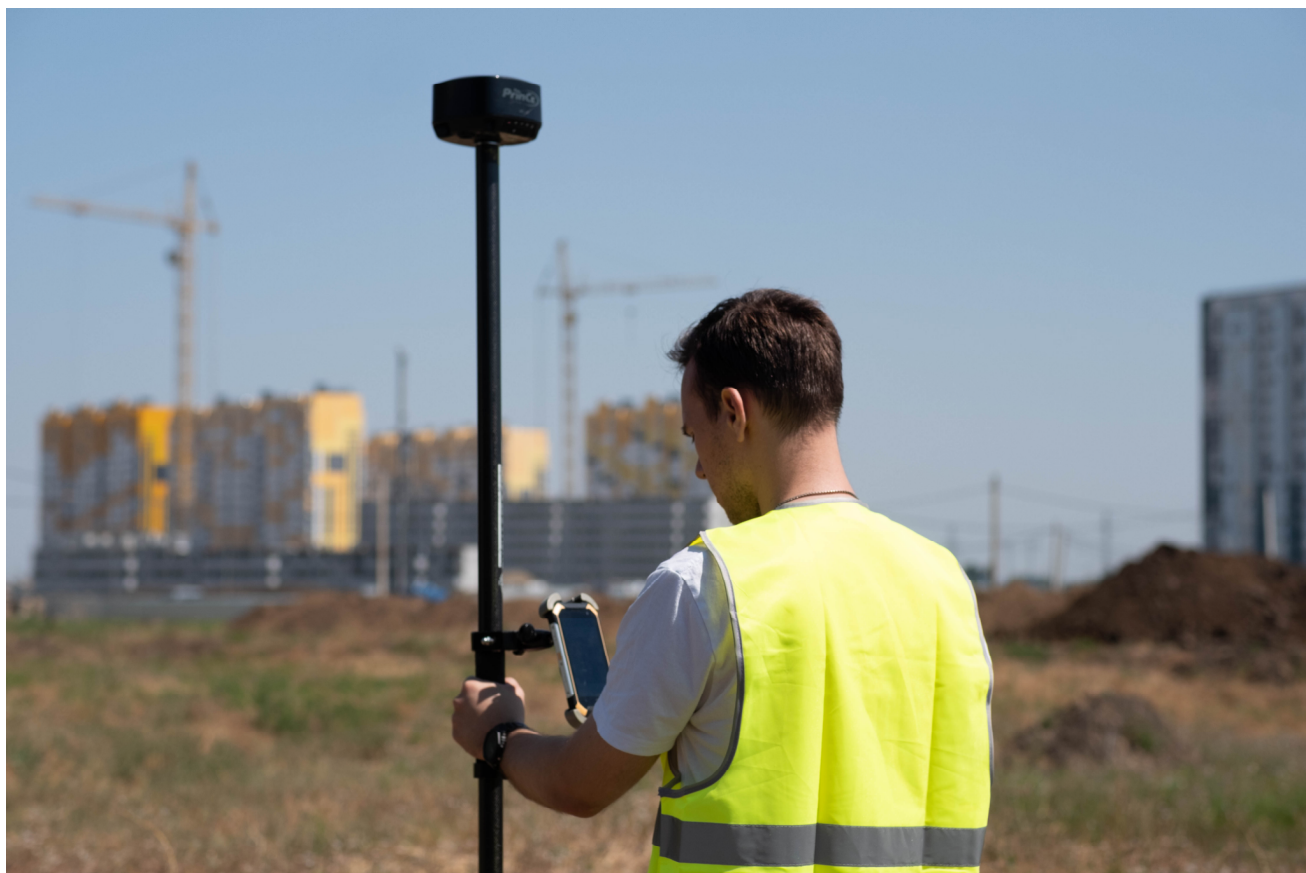
Фото 13 – Выполнение топографической съемки
