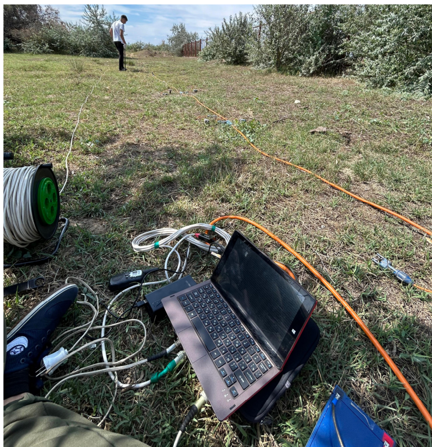
Фото 14 – Выполнение полевых работ по сейсмическому микрорайонированию
