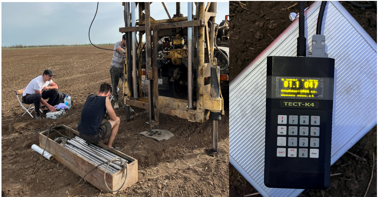
Фото 4 – Проведение статического зондирования
